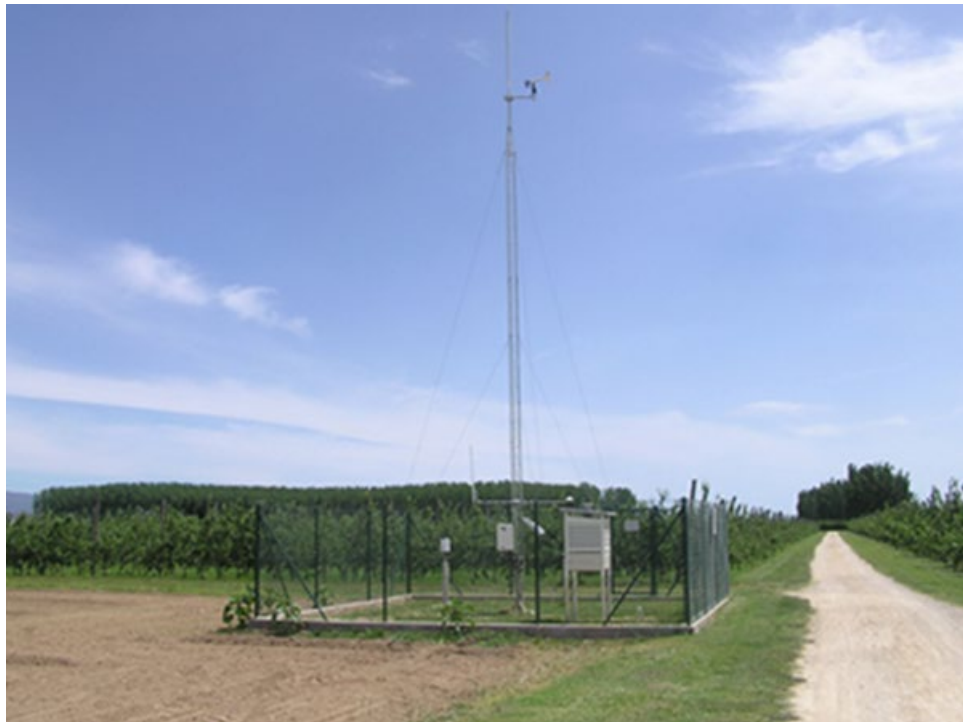
Figura. 3. Al voltant del Baix Ter disposem de diverses estacions meteorològiques que proporcionen dades d'evapotranspiració de referència. Usem dades del darrer dia i també d'històriques d'anys anteriors per fer prediccions.
