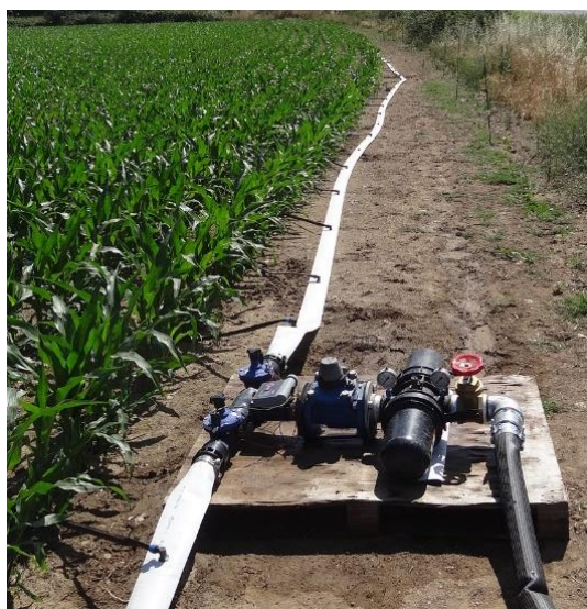
FIGURES 6 i 7. Models de capçals de reg per degoteig. El primer, provisional, durant la durada del cultiu; el segon, permanent, dins d'una caseta de reg.
